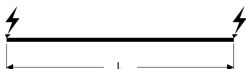
2 подвода питания с торцов L_t = L/4
