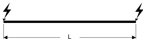
2 подвода питания с торцов L_t = L/4
