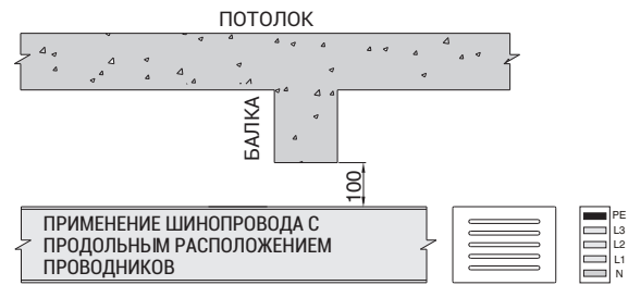
РИСУНОК 5 - ПРИМЕНЕНИЕ ШИНОПРОВОДА С ПРОДОЛЬНОМ РАСПОЛОЖЕНИЕМ ПРОВОДНИКОВ ДЛЯ ПЕРЕХОДА ПОД БАЛКОЙ
