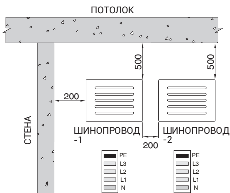
РИСУНОК 3 - ПРИМЕНЕНИЕ ШИНОПРОВОДОВ С ПРОДОЛЬНОМ РАСПОЛОЖЕНИЕМ ПРОВОДНИКОВ
