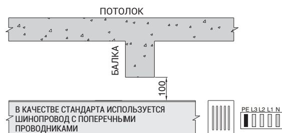
РИСУНОК 4 - ПРИМЕНЕНИЕ ШИНОПРОВОДА С ПОПЕРЕЧНЫМ РАСПОЛОЖЕНИЕМ ПРОВОДНИКОВ ДЛЯ ПЕРЕХОДА ПОД БАЛКОЙ
